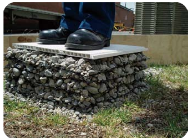
Descripción funcionamiento granulares reforzados con Geomallas.
